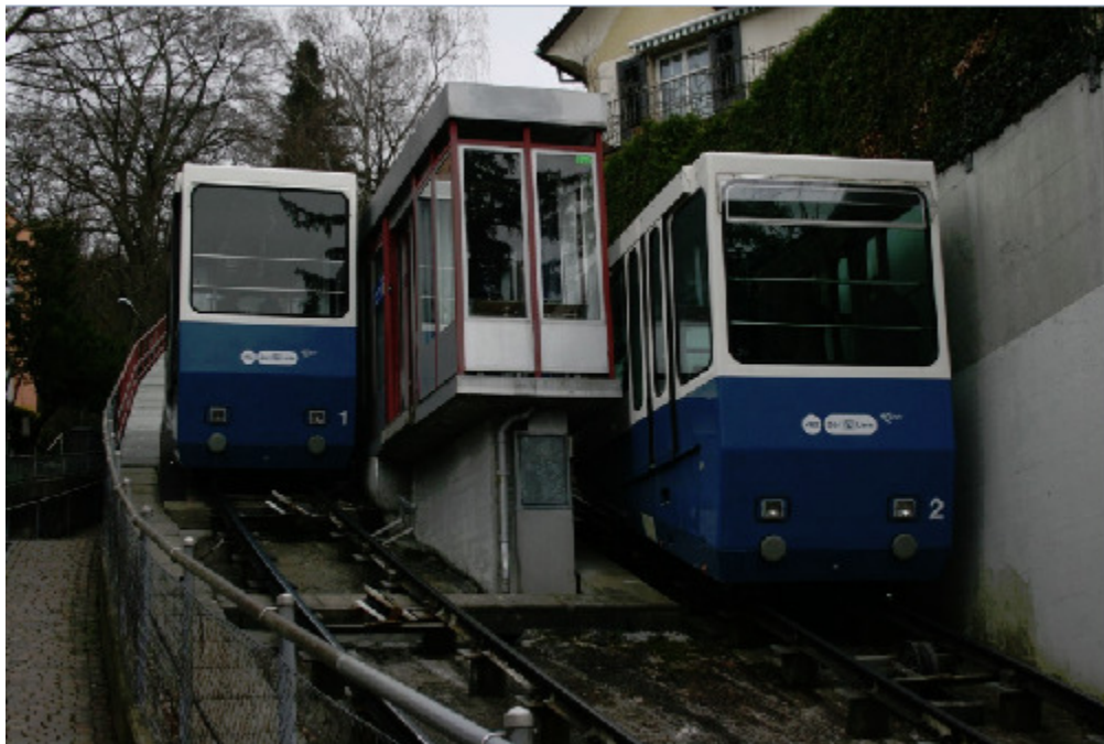
Schienenkreuzung bei der Seilbahn Rigiblick (Zürich)
